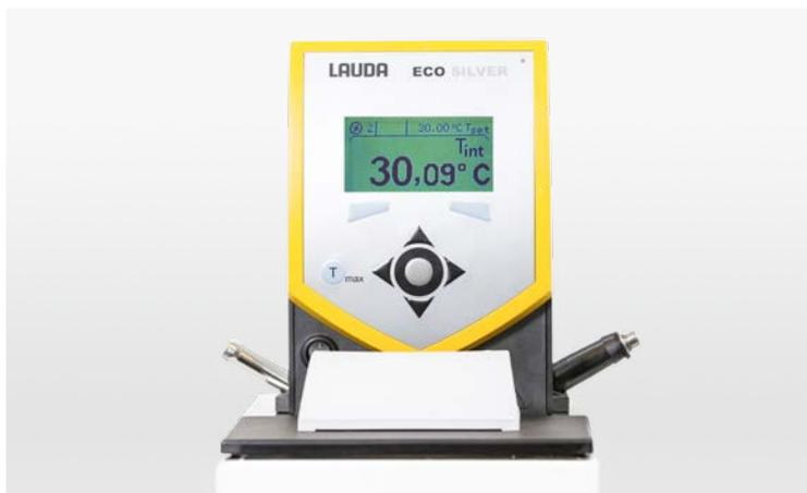
Einfache Bedienung dank Klartext-Menüführung über monochromes LCD- (Silver) bzw. farbiges TFT-Display (Gold)
