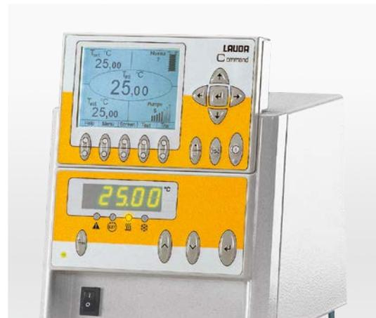
Abnehmbare Fernbedieneinheit für einfache und intuitive Bedienung
