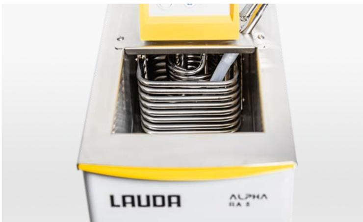
Kostensparnis durch Kompressorautomatik: Kälteleistung wird nur dann zur Verfügung gestellt, wenn sie benötigt wird
