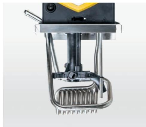
所有的加热恒温器都标配冷却盘管
