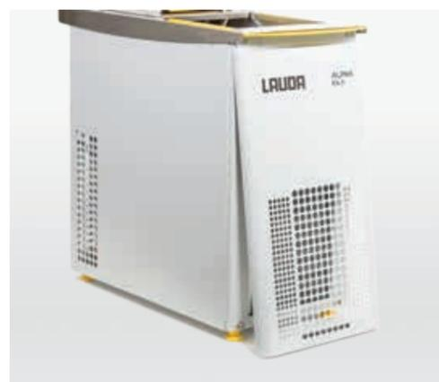
前部冷凝器防护栅格板可以在不使用工具的情况下轻松取下，轻松完成对冷凝器的清洁
