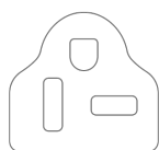
Cable de alimentación con conector (NEMA 6-20P)
