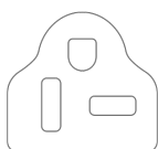
Netzkabel mit Stecker (NEMA 6-20P)
