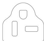
Cable de alimentación con conector (NEMA 6-20P)
