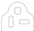
Netzkabel mit Stecker (NEMA 6-20P)
