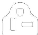
Netzkabel mit Stecker (NEMA 6-20P)
