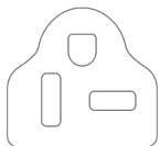
Cable de alimentación con conector (NEMA 6-20P)
