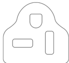
Cable de alimentación con conector (NEMA 5-20P)
