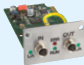
LRZ 922 EtherCAT 带有M8 连接头的模块
