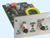
LRZ 922 EtherCAT 带有M8 连接头的模块
