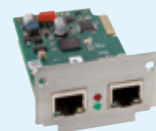
LRZ 923 EtherCAT 带有RJ45 接头的模块
