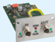
LRZ 922 EtherCAT 带有M8 连接头的模块
