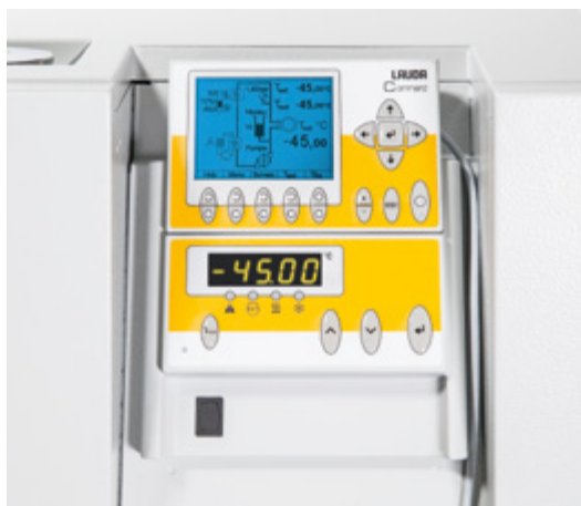
使用可轻松拔插的远程控制器实现了简单和直观的操作
