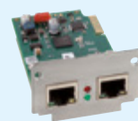
LRZ 923 EtherCAT 带有RJ45 接头的模块
