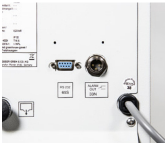
标配RS 232通信接口和故障报警接触器
