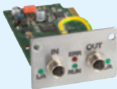
LRZ 922 EtherCAT 带有M8 连接头的模块
