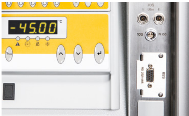
标配RS232/485通信端口和2个扩展插槽实现灵活地系统集成
