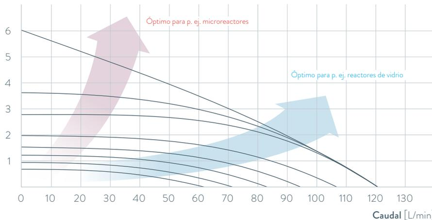
Los Integral XT y P utilizan una bomba Vario de ocho etapas, robusta y estanca, con acoplamiento magnético y curva característica seleccionable, para llevar a cabo un suministro fiable al consumidor, incluso en condiciones de alta resistencia al flujo. La selección de la etapa de la bomba a través del menú permite una conexión térmica óptima de la aplicación con la presión de descarga y el caudal necesarios.
