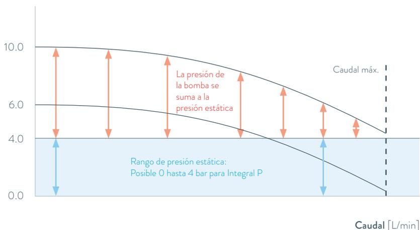
En el Integral P, la presión del sistema puede controlarse mediante la combinación de la presión estática y la presión de la bomba.
