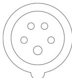
Cable de alimentación con conector (IEC 60309, 5 polos, CEE, rojo, 32 A)
