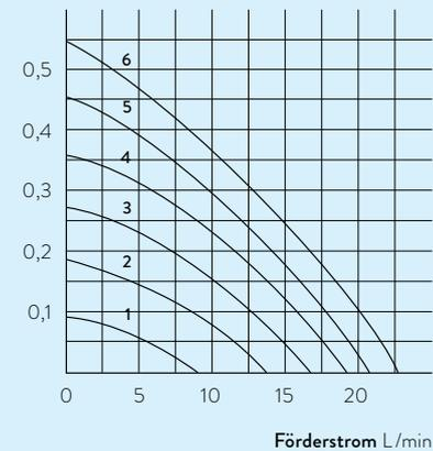
**PUMPENKENNLINIEN** für PB und PBC, Flüssigkeit: Wasser
