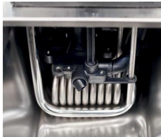
Kühlschlange serienmäßig bei allen Wärmethermostaten enthalten
