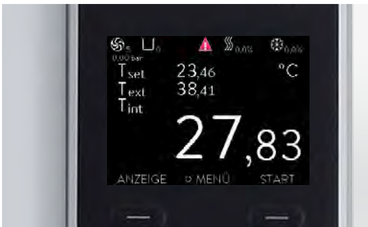
Pantalla TFT con diferentes ventanas o gráfico de temperatura
