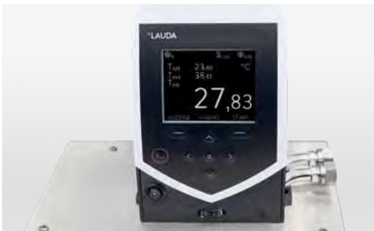
Menú de navegación con texto legible a través de una pantalla LCD monocromo (Silver) o TFT de color (Gold) para un manejo fácil y comprensible
