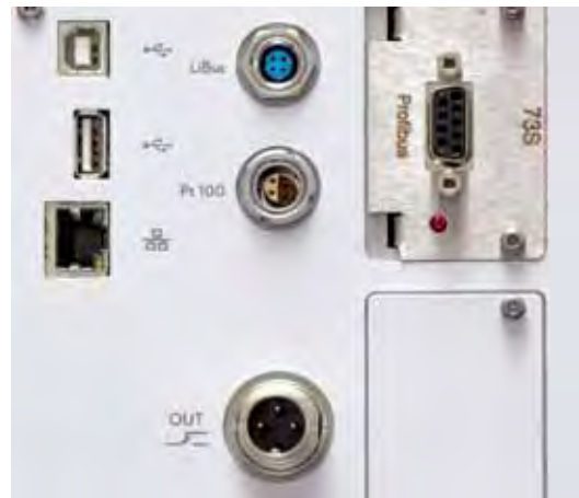
Ethernet, USB, contacto para fallos, así como Pt100 de serie, dos posiciones de módulos para interfaces adicionales
