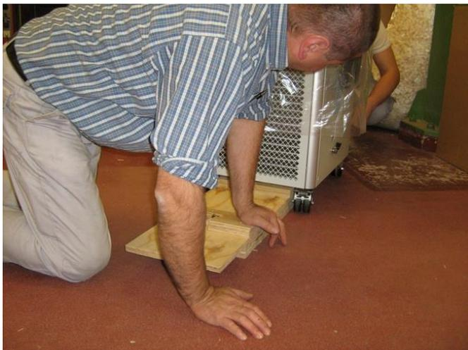
Inserire il supporto di trasporto con le nervature verso l'alto, prestare attenzione alla sua posizione. Il lato più lungo del supporto di trasporto (con nervatura passante) deve trovarsi sul lato anteriore dell'Integral XT.
