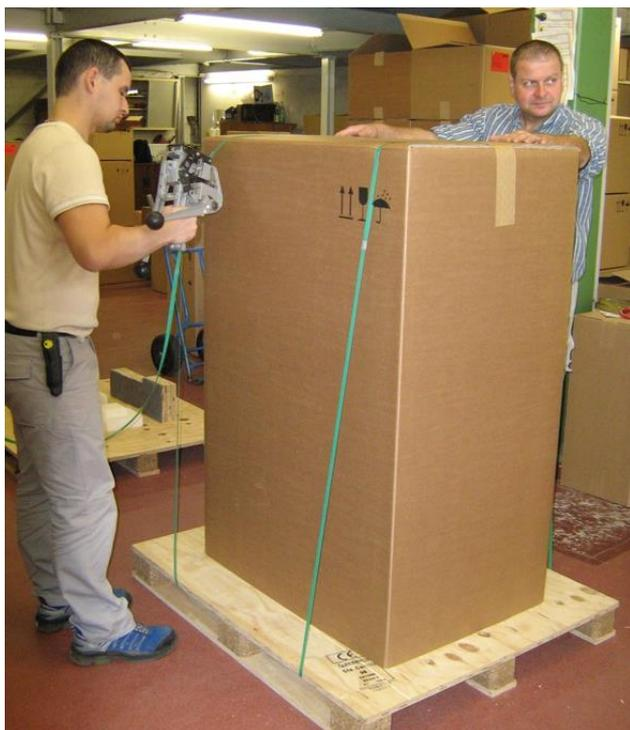
Fissare due volte il cartone dell'imballo di rivestimento sul lato più lungo e una volta sul lato più corto.
