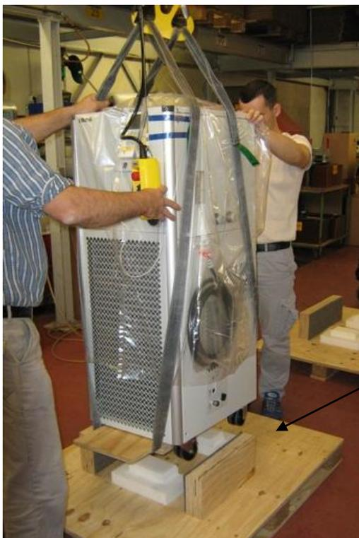
Sollevarlo l'apparecchio e collocarlo sul pallet, prestare attenzione a fissare con precisione l'apparecchio sul pallet. Prestare attenzione alla rientranza per i collegamenti dell'acqua. (L'apparecchio si trova ora collocato liberamente su ammortizzatori in plastica (Tecno-schiuma)).
