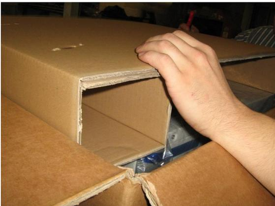
Inserire dapprima il primo cartone distanziatore in alto (⇒ 5.3.5.1). Le due bordature fissano l'apparecchio nella parte anteriore e posteriore.
