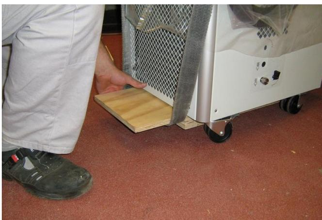
Fissare le cinghie di trasporto (senza catena) su entrambi i lati del supporto di trasporto, prestare attenzione al fissaggio dell'apparecchio!
