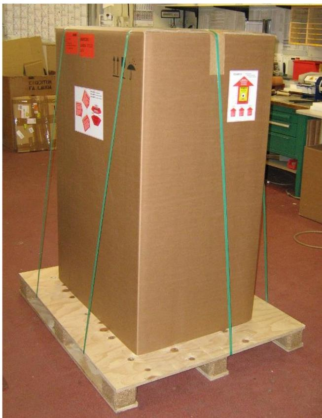
Applicare l'adesivo e il rilevatore d'urto.
