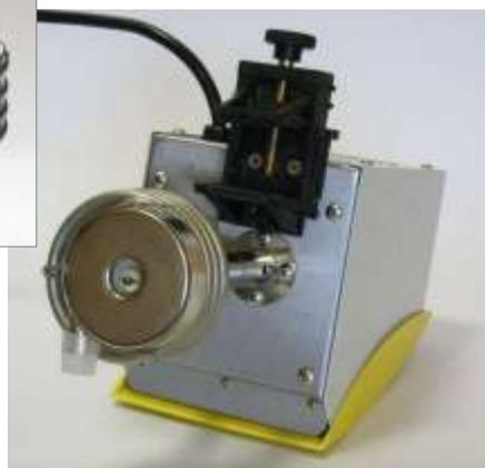
Colocar el aparato sobre una superficie plana. En caso necesario, inserte el control de paso R en la salida de bomba interna. De lo contrario, en baños pequeños la potente bomba podría hacer desbordar del baño el líquido caloportador.
