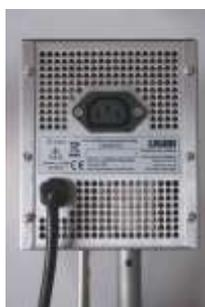
La targhetta si trova sul retro della testa di controllo nei termostati/termostati a immersione.
