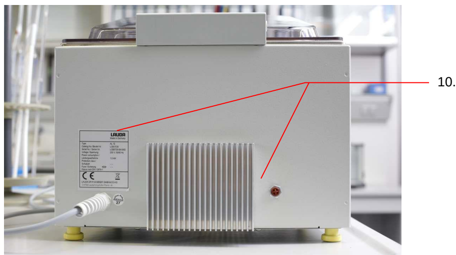
10. Plaque signalétique et touche de réinitialisation du limiteur de surchauffe.
