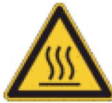
Auf dem Gerät ist das grafische Symbol "Heiße Oberfläche" aufgebracht. Mit diesem Symbol wird vor heißen Oberflächen des Geräts gewarnt. Diese Oberflächen dürfen im Betrieb nicht berührt werden. Um diese Oberflächen in anderen Lebensphasen zu berühren, wie beispielsweise bei der Instandhaltung, müssen diese auf Raumtemperatur abgekühlt werden.
