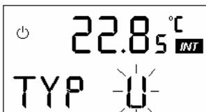
– **Typ** = Ausgangssignaltyp; Spannung 0...10 V (U) oder Strom 0...20 mA (4...20 mA) (I).
