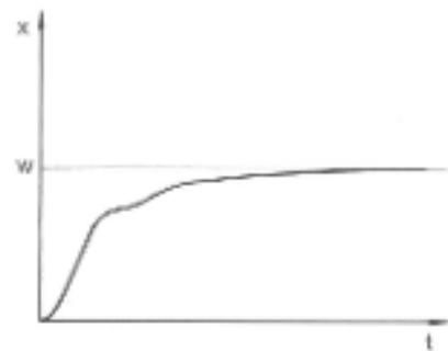
Abb. 32: Regelparameter  $T_n$  und  $T_v$  zu groß
