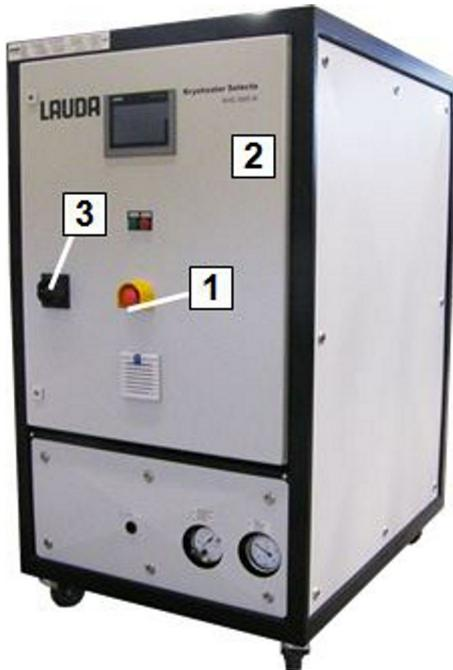
Fig. 1: Posición del botón de parada de emergencia
