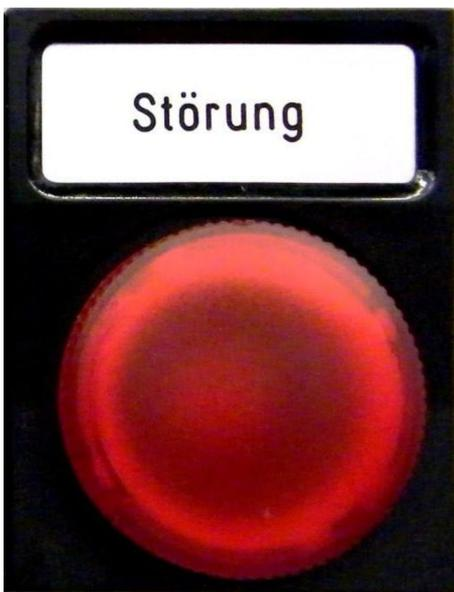
En caso de avería, se ilumina la lámpara de avería (Fig. 78). La lámpara de avería se encuentra en el panel indicador del panel de manejo.
