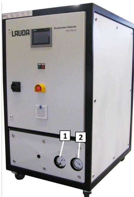
Abb. 77: Druckanzeige Pumpe
