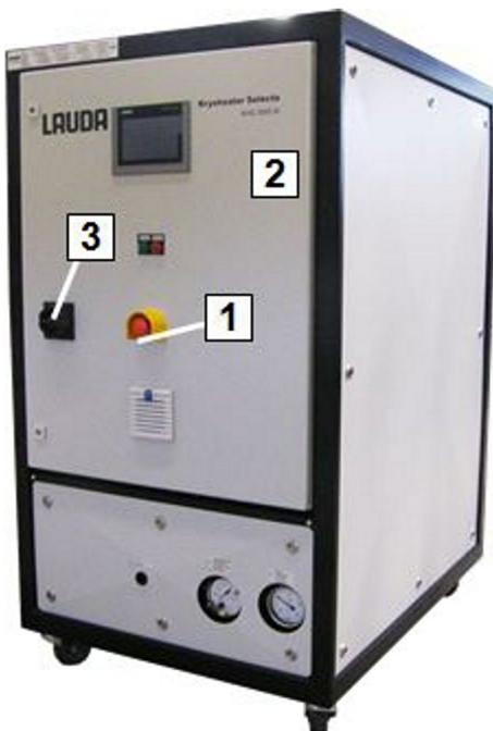
Abb. 1: Lage Not-Halt-Taster und Sicherheitsventil
