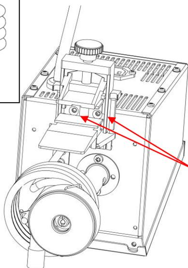
Installare l'apparecchio su una superficie piana. Se necessario, inserire il riduttore di portata **R** sull'uscita interna della pompa. In piccoli bagni, altrimenti, la pompa potrebbe far traboccare fluido di termoregolazione oltre il bordo del bagno.
