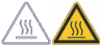
设备上贴有表示“小心烫伤”的标志，该标志表示谨防因设备表面过烫而被烫伤。因此，操作期间不得触摸这些表面。如需执行维修保养等其他程序，须先让设备表面冷却至室温，然后才能操作。
