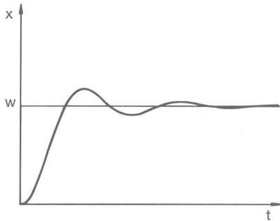
Fig. 34: Control parameters  $T_n$  and  $T_v$  too small
