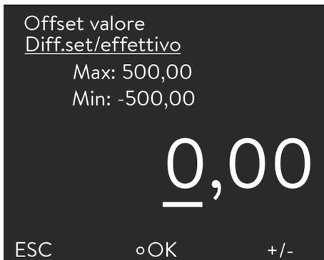
Fig. 31: Definizione del valore di offset
