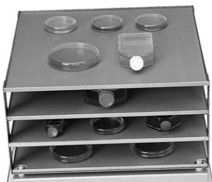
Telai supplementari per l'incremento della capacità dell'agitatore, in "acciaio inox", con 4 piani di alloggiamento
