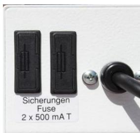
Nei due portafusibili posti sul lato posteriore dell'apparecchio si trovano i fusibili elettrici di rete F1 e F2, interni all'agitatore. Per verificare e sostituire questi fusibili è possibile estrarre i cassettei agendo sulle leve di arresto.
