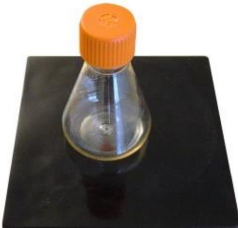
Haftmatte schwarz. Haftstarke Spezialmatte zur einfachen Befestigung unterschiedlichster Gefäße, Schüttelgeschwindigkeit bis ca.  $250 \text{ min}^{-1}$  (abhängig von Form und Gewicht des Gefäßes und Größe der Schüttelamplitude).
