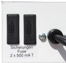
In den zwei Sicherungshalterungen an der Geräterückseite befinden sich die geräteinternen, elektrischen Netzsicherungen F1 und F2 des Schüttelapparates. Zur Überprüfung und zum Austausch dieser Sicherungen können die Schubladen nach Betätigen der Haltehebel herausgezogen werden.
