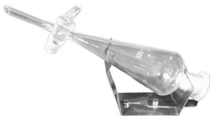
Pinzas para embudos de decantación, de "acero inoxidable". Se suministra completo con material de fijación para atornillar a un estante.
