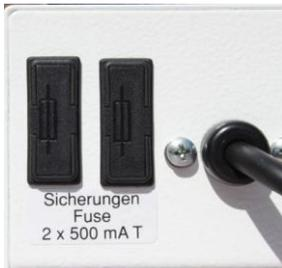
Los dos portafusibles situados en la parte posterior del equipo contienen los fusibles de red internos F1 y F2 del agitador. Para comprobar y sustituir estos fusibles, se pueden extraer los cajones tras accionar las palancas de retención.
