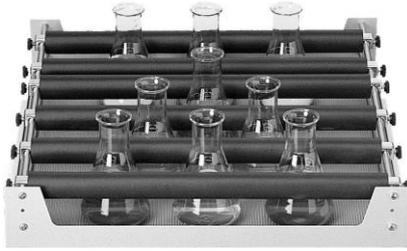
Soporte universal para la sujeción segura de diferentes objetos de agitación entre los travesaños con revestimiento de goma
