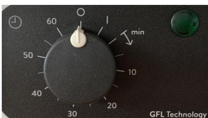
Para un funcionamiento continuo, gire el botón de ajuste izquierdo hasta la primera línea, el botón encaja en esta posición. El agitador se apaga girando el botón en sentido contrario a las agujas del reloj hasta la posición 0. Para el funcionamiento con limitación de tiempo, gire botón de ajuste hasta la escala, más allá de la posición de ajuste del funcionamiento continuo. La escala muestra
