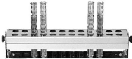
Soporte para tubos de ensayo, la parte perforada puede girarse 90°, con muelles de compresión para una sujeción firme y una agitación silenciosa de los tubos. Se suministra completo con material de fijación para atornillar a un estante
