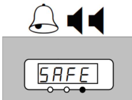
Fig. 7: Alarma de exceso de temperatura
