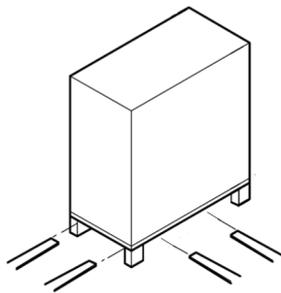
Fig. 1: Transporte con la carretilla elevadora de horquilla
