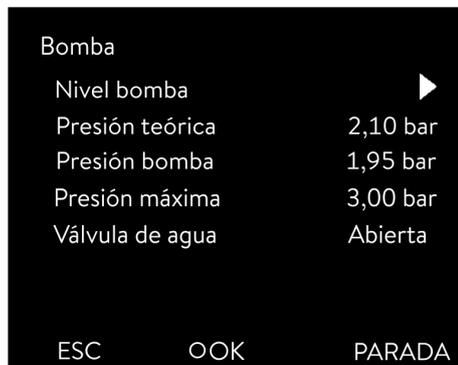
Fig. 29: Menú Bomba en Integral IN XT
