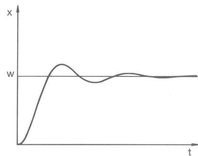
Fig. 76: Parámetros de regulación  $T_n$  y  $T_v$  demasiado bajos
