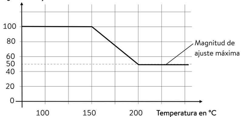
Fig. 42: Limitación dinámica de la potencia calorífica
