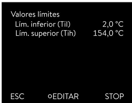
Fig. 44: Fijar los valores límites de temperatura
