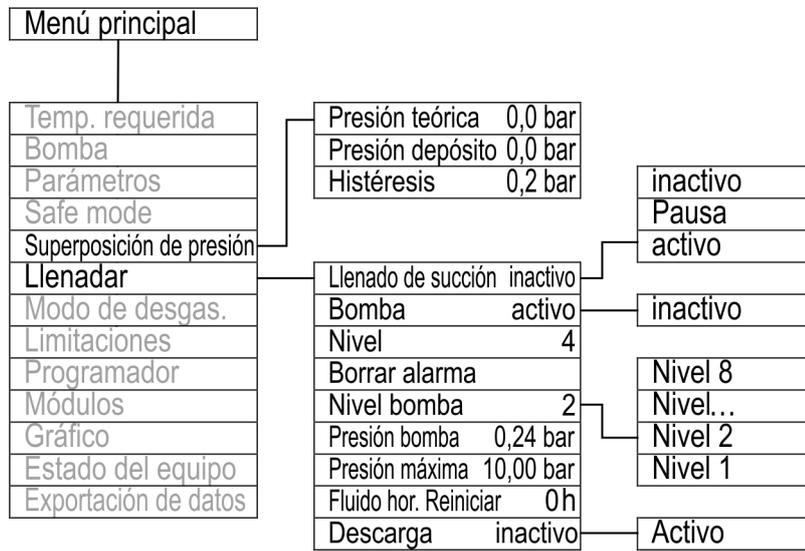
Fig. 35: Estructura del menú de la superposición de presión
