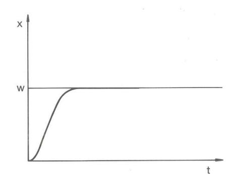
Fig. 73: Ajuste óptimo
