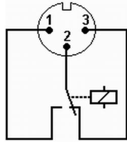
Fig. 13: Clavija con brida (frontal) en estado de error
