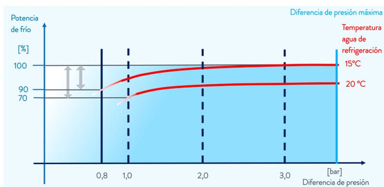
Fig. 94: Diferencia de presión del agua de refrigeración
