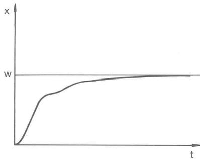
Fig. 77: Parámetros de regulación  $T_n$  y  $T_v$  demasiado altos
