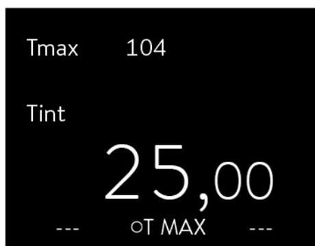
Avec la touche  $T_{max}$ , vérifiez ou modifiez le point de coupure de surtempérature :
