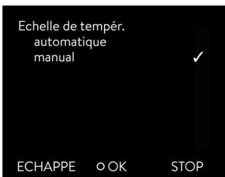
Dans l'option **Echelle de température** vous pouvez définir l'échelle de l'axe des y (température).
