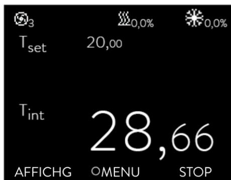
L'écran affiche la température actuelle du bain ( $T_{int}$ ), l'état de l'appareil et l'état général dans la barre supérieure en haut de l'écran et la barre des onglets en bas de l'écran.
