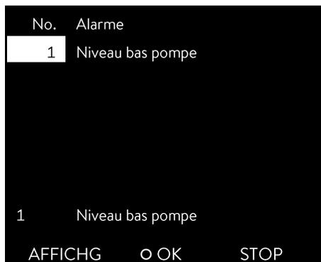
Une alarme double se déclenche lorsque le niveau de liquide caloporteur baisse et que le corps de chauffe n'est plus totalement immergé. L'écran affiche « Niveau bas pompe », le chauffage coupe tous les pôles, pompe et groupe réfrigérant sont coupés par l'électronique.
