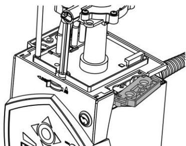
Le serpentin de refroidissement ne peut être fixé que sur un seul côté de la tête de contrôle. C'est du côté de l'interrupteur secteur (voir illustration).
