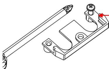
Réaliser l'empreinte du filetage sur la vis
