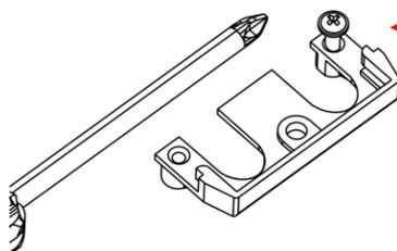
Réaliser l'empreinte du filetage avec la vis
