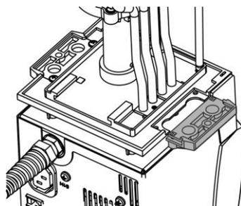
Le kit de refroidissement ne peut être fixé que sur un seul côté de la tête de contrôle. (voir illustration)
