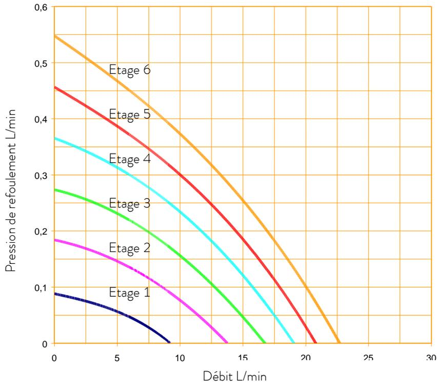
Courbes caractéristiques de la pompe, mesurées avec de l'eau
