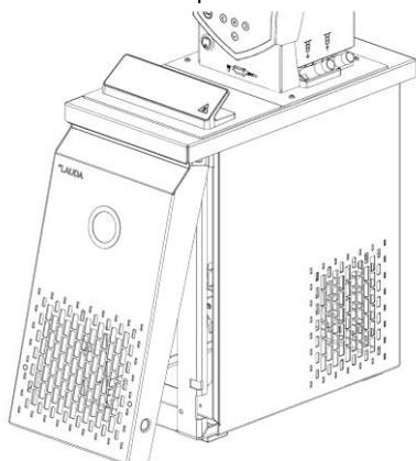
Le circuit de réfrigération est pratiquement sans entretien. Enlevez régulièrement la poussière et la saleté du condenseur (en fonction de la durée de fonctionnement et des conditions d'exposition).
