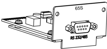
Module d'interface RS 232/485 (LAUDA réf. n° LRZ 913) avec douille D-sub 9 pôles, séparé galvaniquement par des coupleurs optoélectroniques. Avec un jeu de commande LAUDA compatible avec les séries Ecoline, Proline, Integral XT et Integral T.
