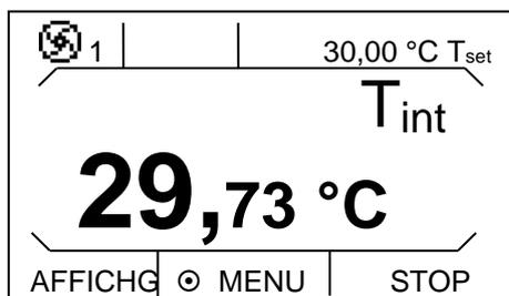
L'écran affiche la température actuelle du bain  $T_{int}$ , l'étage de la pompe à côté du symbole pompe, la température de consigne  $T_{set}$  et la barre des onglets en bas de l'écran.
