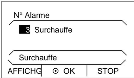
Lorsque la température du bain est supérieure au point de coupure de surtempérature, un double signal sonore retentit et l'écran affiche « Surchauffe », le chauffage s'éteint sur tous les pôles, la pompe et le groupe frigorifique sont coupés via l'électronique.
