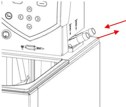
Si on utilise le thermostat en mode de thermostat à circulation, il convient d'utiliser les connexions de flexibles avec la plus grande section interne possible pour assurer le plus grand volume de circulation possible.
