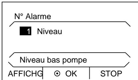
Une alarme double se déclenche lorsque le niveau de liquide caloporteur baisse et que le corps de chauffe n'est plus totalement immergé. L'écran affiche « Niveau bas pompe », le chauffage coupe tous les pôles, pompe et groupe réfrigérant sont coupés par l'électronique.
