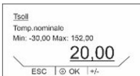
Fig. 31: Inserimento della temperatura nominale
