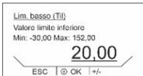
Fig. 30: Impostazione del valore limite di temperatura
