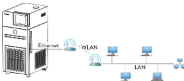
Fig. 14: collegato tramite LAN e WLAN
