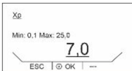
Fig. 54: personalizzazione del parametro di regolazione Xp
