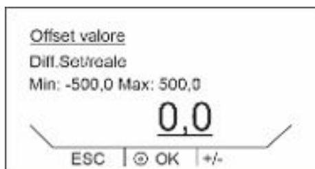
Fig. 41: Inserimento del valore di offset
