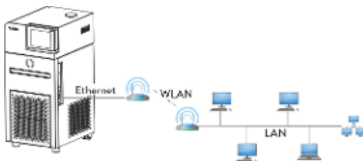
Fig. 16 : Connexion par réseau local et WiFi
