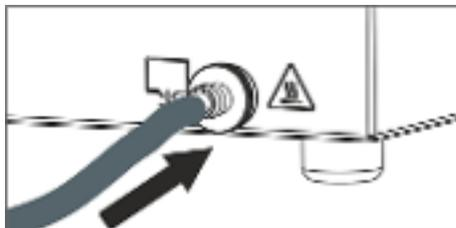
Abb. 23: Schlauch aufstecken
