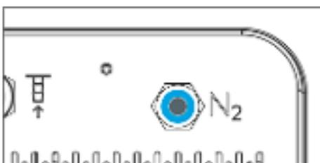
Abb. 8: Anschluss für Stickstoff (N<sub>2</sub>)
