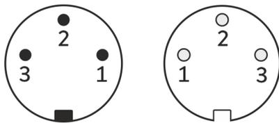
Fig. 8: Contactos salida/entrada
