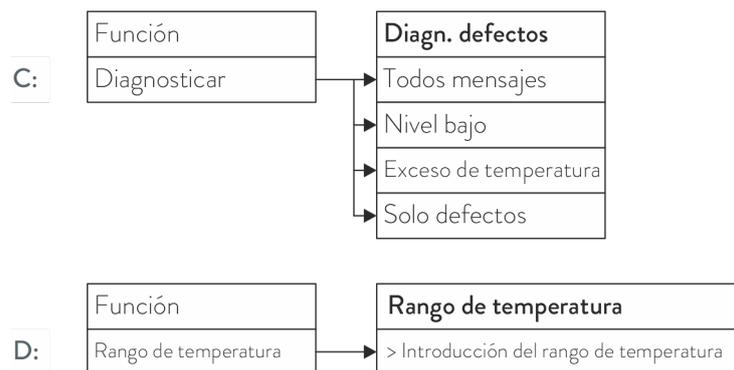
Fig. 14: Salida de contacto, menús de diagnóstico de error y rango de temperatura
