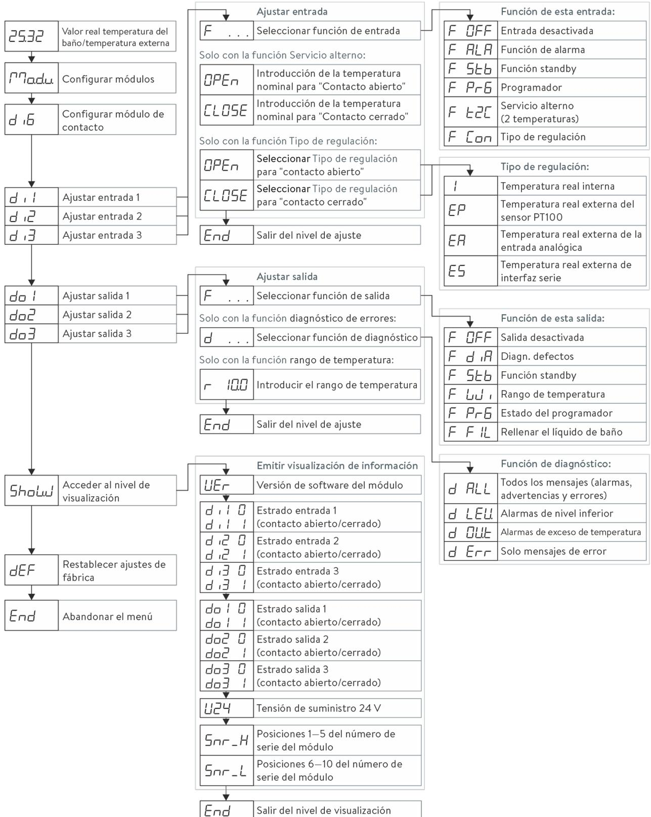
Fig. 15: Menú del módulo de contacto en la unidad de mando Master
