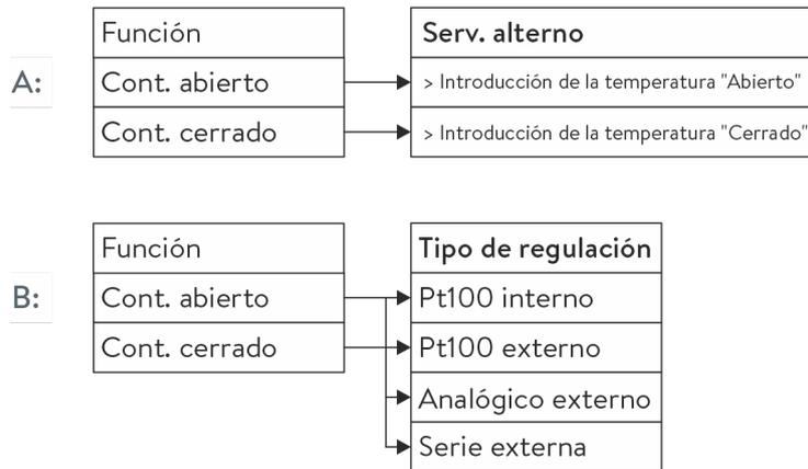
Fig. 13: Entrada de contacto, menús de servicio alterno y modo de regulación
