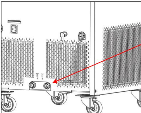
Wasserzulaufschlauch am Gerät lösen und Filter entnehmen. Filter reinigen und wieder in den Kühlwasserzulauf einsetzen.
