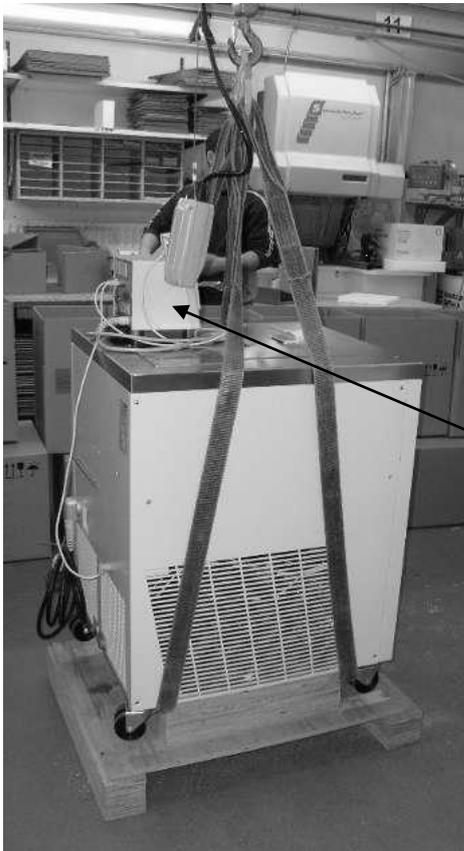
Legen Sie die Gurtschlaufen zwischen Palette und den Rädern um das Gerät und führen Sie die Gurtschlaufen über der Gerätemitte zusammen. Heben Sie das Gerät anschließend von der Palette.
