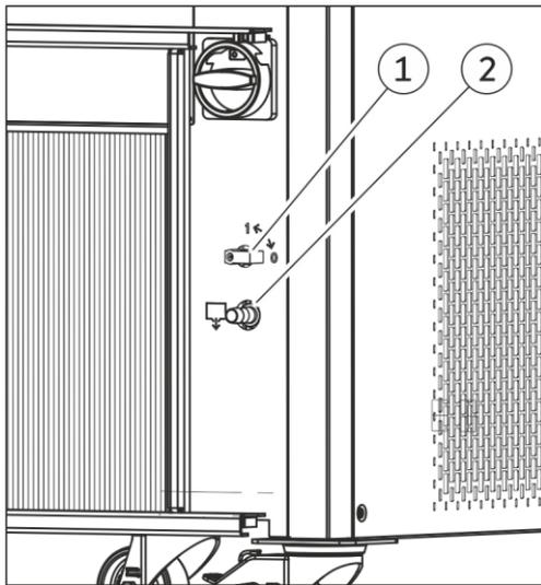
Bei geöffneter Frontblende Zugang zur Entleerungseinrichtung:
