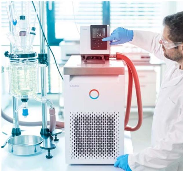
Les bains thermostatés LAUDA Universa créent des conditions idéales pour le contrôle précis de la température des réacteurs :
