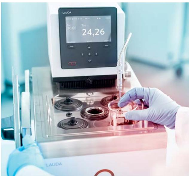
LAUDA Universa offre la possibilité de calibrer des capteurs, des thermomètres ou des composants :
