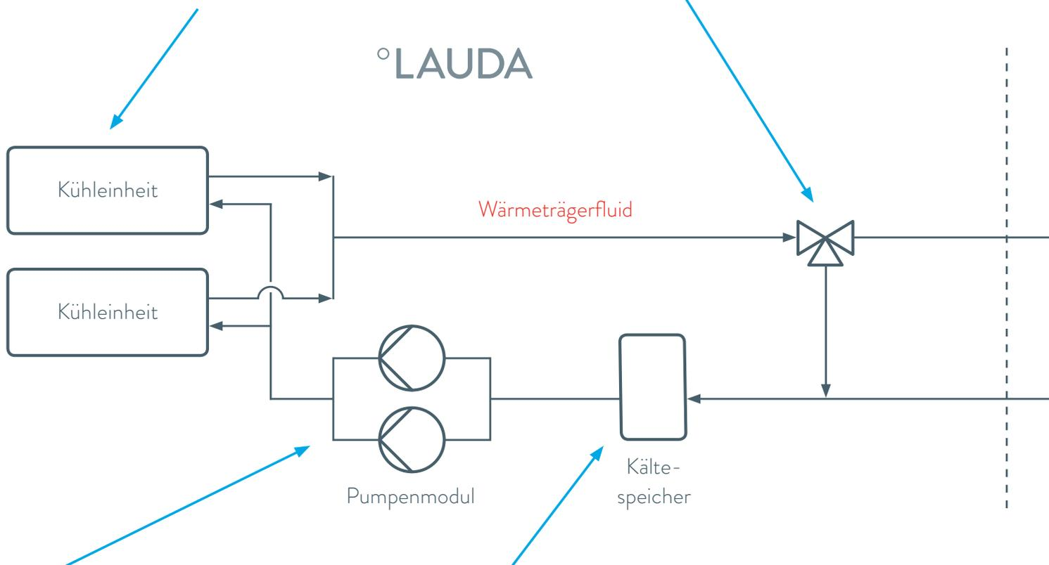
**Pumpenmodul**, kann mit einer leistungstarken Pumpe oder redundant mit einer zusätzlichen Pumpe ausgeführt werden, um die Ausfallsicherheit zu erhöhen. Die Pumpenleistung wird anwendungsspezifisch ausgelegt.
