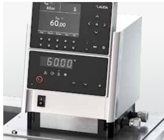
Abnehmbare Fernbedieneinheit für einfache und intuitive Bedienung
