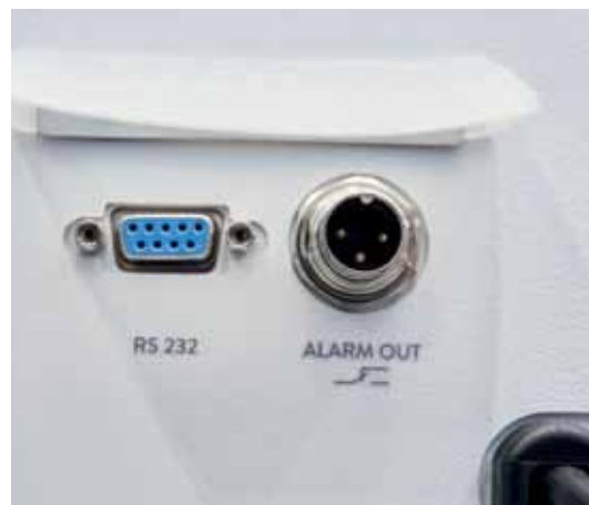
Serienmäßige RS-232-Schnittstelle und Alarmkontakt
