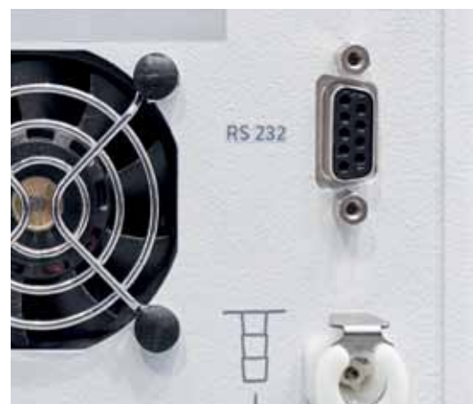
Serienmäßige RS 232-Schnittstelle zur Systemintegration in Prozesse
