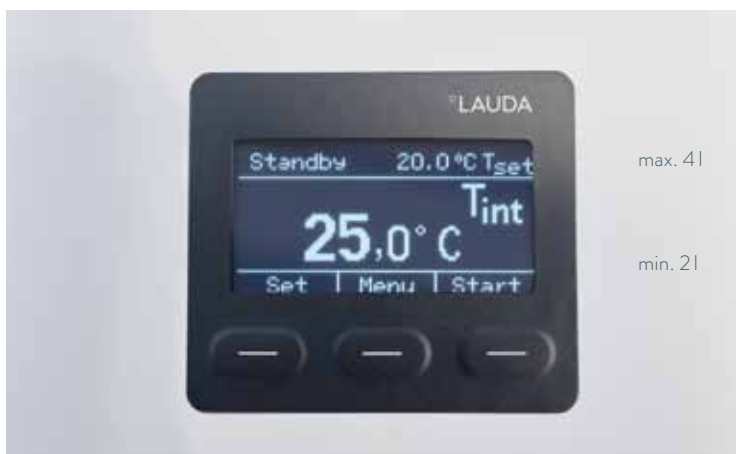
Einfache 3-Tasten Bedienung mit OLED-Display
