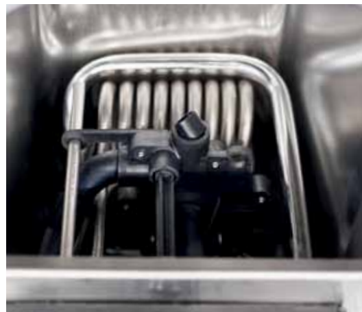
Kühlschlange serienmäßig bei allen Wärmethermostaten enthalten
