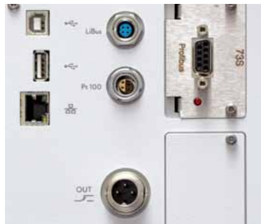
Ethernet, USB, Störkontakt sowie Pt100 serienmäßig, zwei Modulplätze für zusätzliche Schnittstellen
