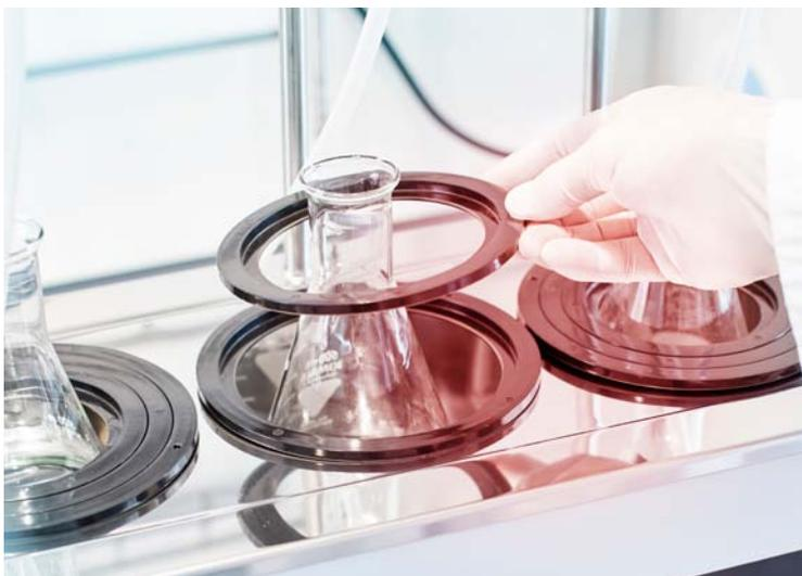
Abnehmbare Lochdeckel aus mehrteiligem Ringsatz
