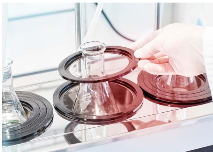
Cubierta perforada desmontable compuesta por un juego de varios anillos
