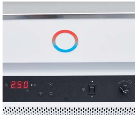
Elementos de manejo en el lado izquierdo: ajuste de la temperatura con indicador LED, lado derecho: ajuste del número de revoluciones de la unidad agitadora
