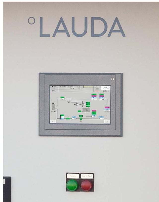
Panneau de commande du système de refroidissement industriel de process
