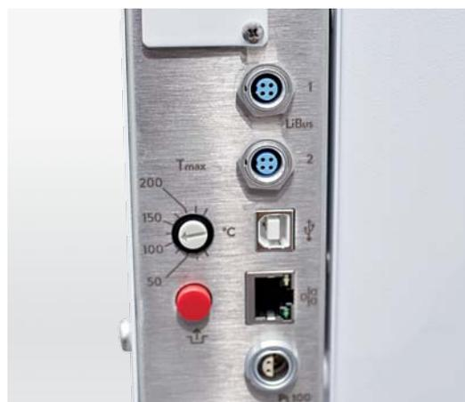
Interfaces Ethernet et USB et raccord Pt100
