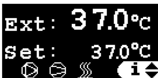
La schermata principale mostra la temperatura corrente nell'applicazione esterna (Est) o la temperatura dell'acqua in uscita (Out) a seconda del tipo di controllo, del setpoint corrente e mostra quali elementi nell'unità sono attualmente attivi.
