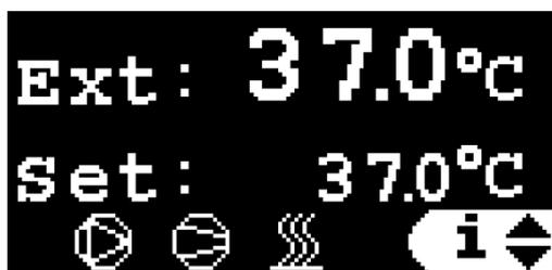
L'écran principal affiche la température actuelle de l'application externe (Ext) ou la température de l'eau de sortie (Out) en fonction du type de contrôle, le point de consigne actuel et les éléments de l'appareil qui sont actuellement actifs.
